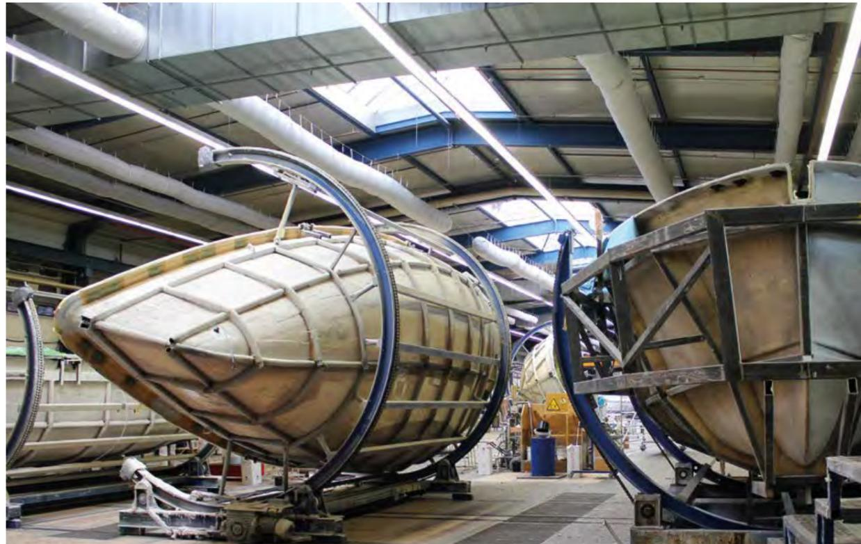
Zwischenzeitliche Trocknungszeiten werden überbrückt, indem das Laminiererteam von Boot zu Boot wechselt. Die Formen sind außerdem drehbar gelagert, so dass auch innerhalb einer Form, alternierend erst auf einer, später auf der anderen Seite laminiert wird.
